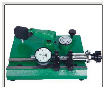
检验百分表的精度(测量范围0-25mm)
